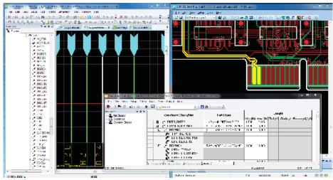
在原理图或 Layout 中,使用基于电子表格的编辑器设置设计约束。
