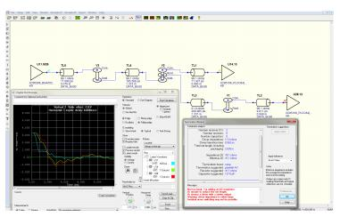
确定布线约束,并借助 PADS Standard Plus 信号完整性分析以及 HyperLynx®技术提供的支持来验证完成布线的 PCB。
