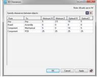
PADS Standard Plus 可基于您的 PCB 设计约束和间距定义执行 3D 设计规则检查。
