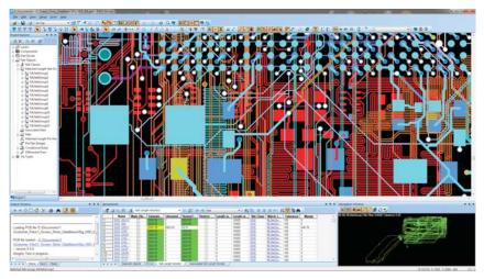
利用高级 PCB 模块,可实现高速约束的自动布线。
